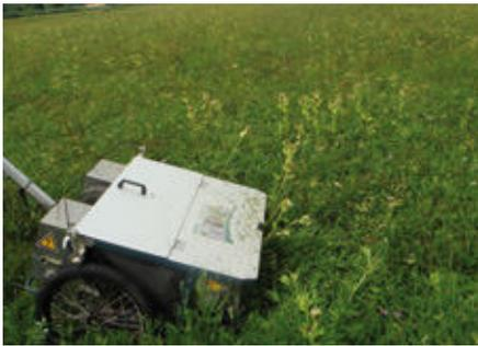
Ernte mit dem E-beetle: Mit einem Bürstensystem werden die Samen aus den artenreichen Wiesen ausgebürstet.
